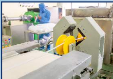
DISPOSITIVO DE INSPEÇÃO LASER AUTOMÁTICA
